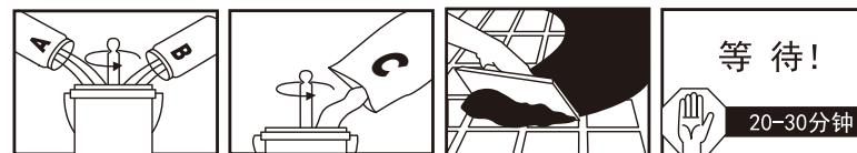
① 充分混合A和B两种液体 ② 再加入C组份搅拌均匀 ③ 用橡皮抹刀填缝 ④ 视环境时间会有不同
