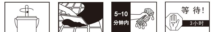
① 搅拌均匀。 ② 沿接缝的对角线方向进行涂抹，将所有的接缝填满并压实。 ③ 10分钟内，将海绵浸湿后拧干，进行第一次清洗。 ④ 常温下，等待3小时左右。
