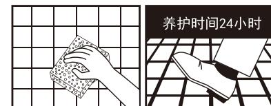
⑨ 用一块干净海绵沿角对线方向除掉残留物 ⑩ 填缝剂完全干透后才可上人
